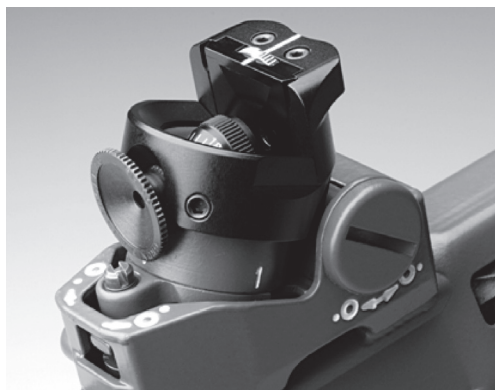
Figura 7: filtro colorato eccentrico con supporto girevole, modello Grünig + Elmiger; modello Wyss simile
