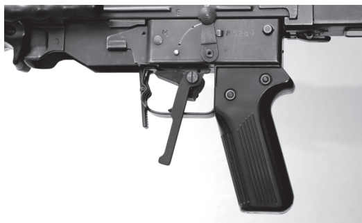
Figure 33: Détente d'hiver pour tireurs gauchers pour F ass 57
